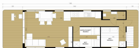
RAUMHÖHE: 212,5cm HOHE DES HAUSBOOTS (VON DER UNTERSEITE DES FLOATS BIS ZUR DACHBEREICHE): 340cm
