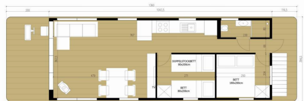
RAUMHÖHE: 212,5cm HOHE DES HAUSBOOTS (VON DER UNTERSEITE DES FLOATS BIS ZUR DACHOBERSSEITE): 340,5cm
