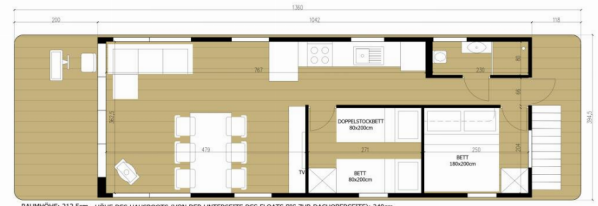
RAUPLÖHE: 212,5cm HÖHE DES HAUSBOOTS (VON DER UNTERSEITE DES FLOATS BIS ZUR DACHBEREICHE): 340cm
