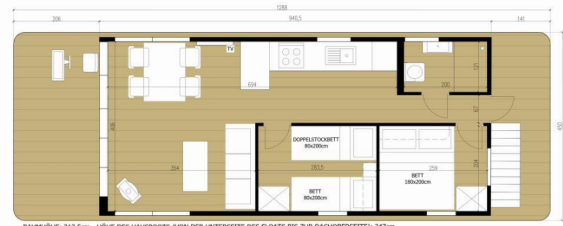
RAUMHÖHE: 212,5cm HÖHE DES HAUSBOOTS (VON DER UNTERSEITE DES FLOATS BIS ZUR DACHBEREICHE): 347cm
